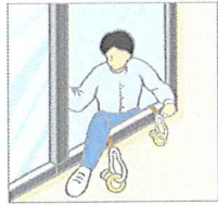
5 6 雙手攀住逃生口，反身面向內，依爬梯方式向下逃生。逃生梯採用高級鋼索與鐵材製造承載量大，可供多人連貫使用。
