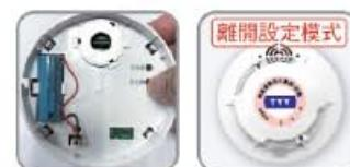
若要設定回子機同上步驟，步驟③則鳴響「設定為子機。」。插上電池連接線：將電池連接線插到本體的電池端子。
